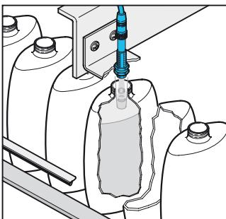
Füllstandskontrolle in engen Behältern (USTI 12 ...)
