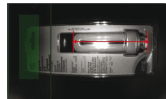
Signalwarnung: Falsches Leuchtmittel in der Verpackung Warning signal: wrong bulb is in the package
