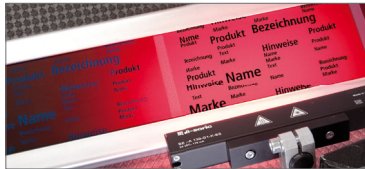
Hervorheben kontrastarmer Merkmale mittels Rotlicht (BE 1-Axxx -G1...) Highlighting low contrast features (BE 1-Axxx -G1...)
