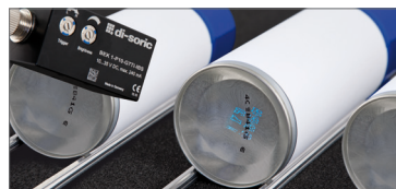
Codeprüfung mittels Codeleser und Punktbeleuchtung während der Fertigung (BEK 1-P ...) Verification of codes with a codereader and a spotlight during production (BEK 1-P ...)
